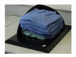
Antena diseñada para ser utilizada en lectura múltiple e inventarios de ropa en almacenes, válida para ropa ordenada en sistema apilada o de forma individual.
